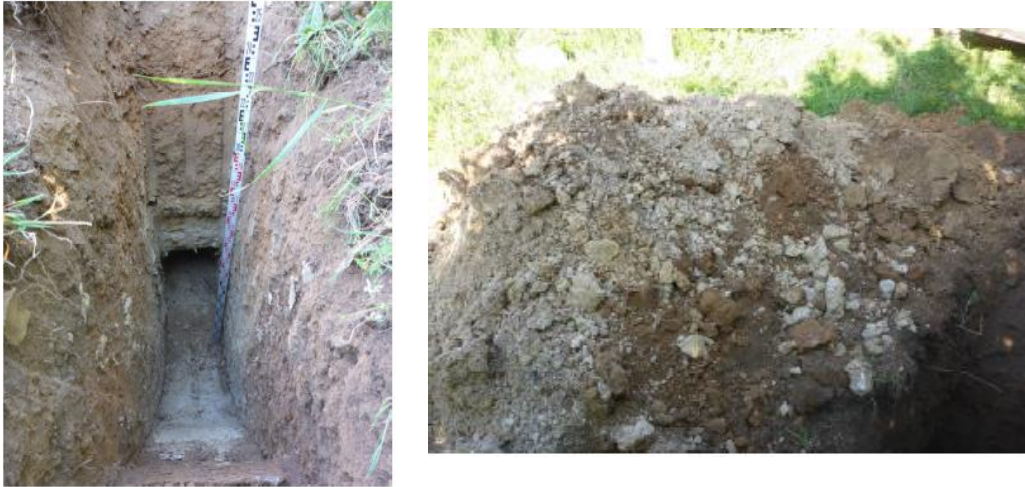
Figure 22 : Terrains argileux identifiés au droit de F1-2019 0 à 1,6 m/TN : argiles limono-graveleuses marron – 1,6 à 3,0 m/TN : argiles sablo-graveleuses rougeâtres
