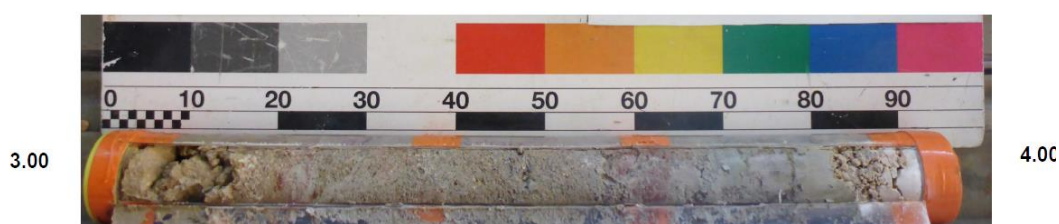
Figure 17 : Argiles à passées rougeâtres, graves calcaires et calcaire identifiés au droit de SC1-2019 entre 3,15 et 4,0 m/TN
