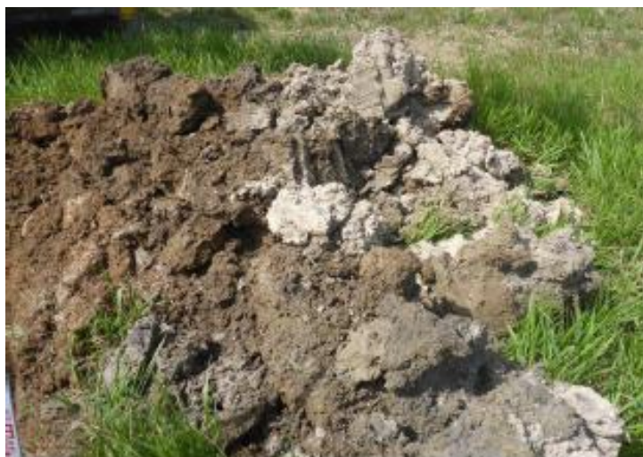
Figure 19 : Argiles limoneuses à graveleuses identifiée au droit de F13-2019
