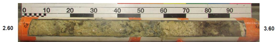
Figure 16 : Argiles à concrétions calcaires identifiées au droit de SC2-2019
