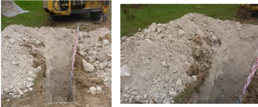
Figure 21 : Graves argileuses à blocs calcaires reconnues en F9-2019
