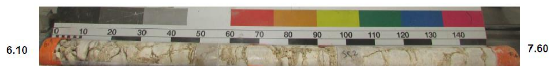
Figure 18 : Calcaire très fracturé à passées marneuses reconnu en SC1-2019
