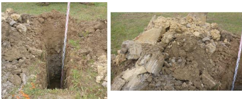
Figure 15 : Argiles limoneuses à graveleuses identifiées au droit de F6-2019
