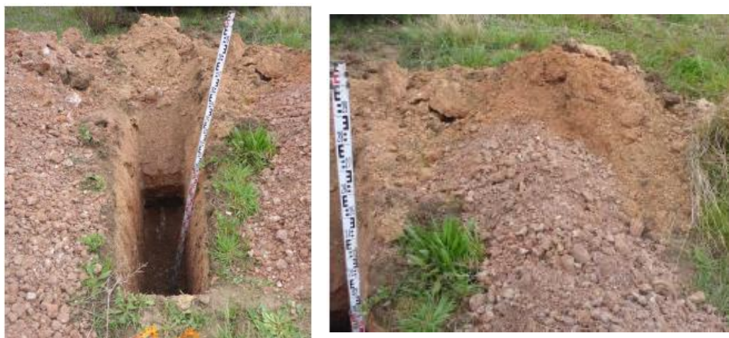
Figure 20 : Argiles sableuses plus ou moins indurées, bariolées rougeâtre à mauves, en F11-2019
