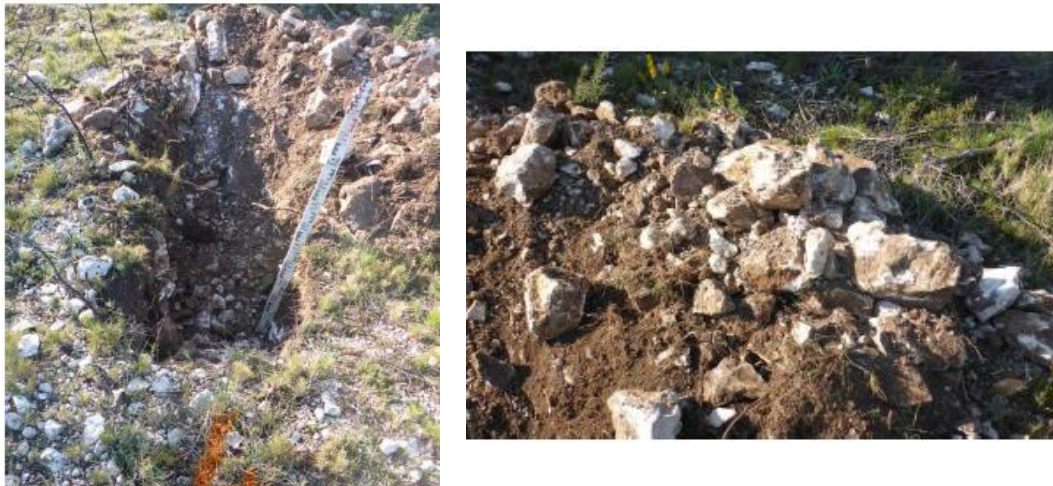
Figure 23 : Graves et blocs calcaires à matrice argileuse reconnues en F4-2019
