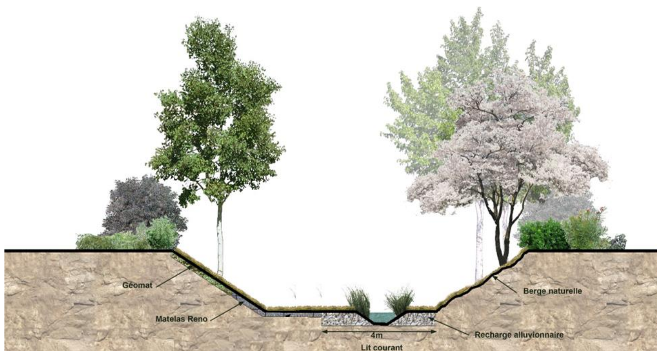
Figure 61 : Coupe type du lit du Rieumassel après réalisation du projet
